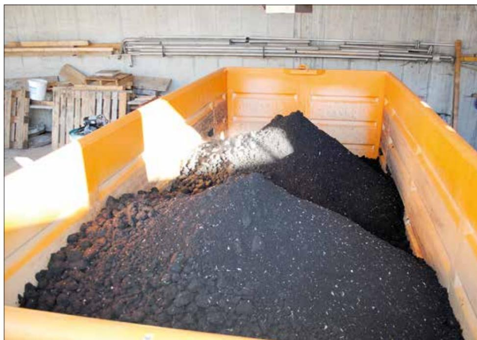
Die weißen Flecken im gepressten Schlamm stammen von den Biomüllsäcken, die sich erst später zersetzen.
